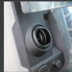
新しいレイアウトのエアコンダクト
